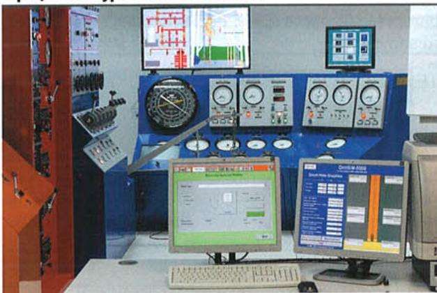
**Рис. 14. Переносной тренажер DrillSIM-20**
